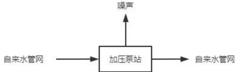
图2-5 加压泵站工艺流程
